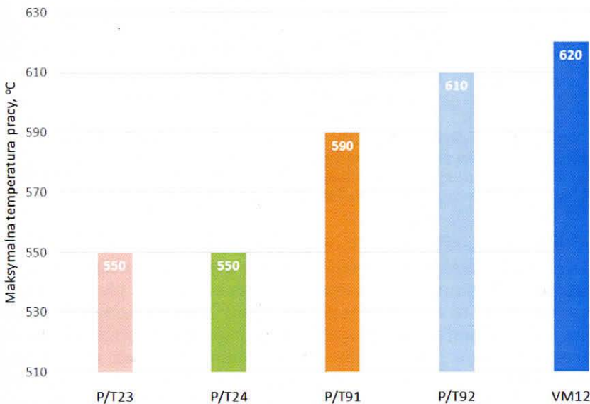
Rys. 1.9. Maksymalna temperatura pracy dla nowoczesnych stali żarowytrzymałych o osnowie ferrytycznej, gdzie: P/T23 (7CrWVMoNb9-6); P/T24 (7CrMoVTiB10-10); P/T91 (X10CrMoVNb9-1); P/T92 (X10CrWMoVNb9-2) i VM12 (X12CrCoWVNb12-2-2)
