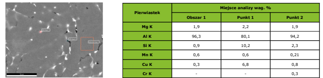
Rysunek 5. Wyniki analizy EDS w spoinie dla stopu 2A
