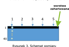
Rysunek 3. Schemat pomiaru twardości próbek po hartowaniu, 5 linii pomiarowych, 40 punktów pomiarowych w jednej linii
