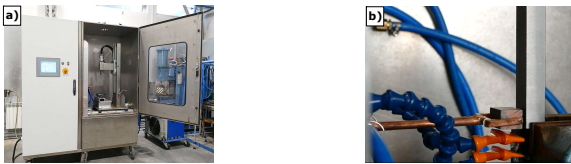
Rysunek 2. a) stanowisko do hartowania powierzchniowego indukcyjnego opracowane w Łukasiewicz – Instytucie Spawalnictwa, b) wzbudnik wraz z układem chłodzenia strumieniem wody
