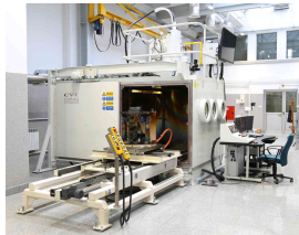
Rys. 1. Urządzenie do spawania i modyfikacji powierzchni wiązki elektronów model XW150:30/756
