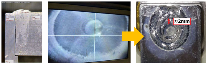
Przykłady obliczonej nieprawidłowej pozycji robota w oparciu o dane wizyjne lub offsetowe
