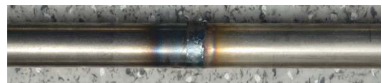
Rys. 6. Widok wybranych zgrzeiny ze stali automatowej 11SMnPb30 (po prawej) oraz stali nierdzewnej AISI304 (po lewej) po obróbce mechanicznej za pomocą przesuniętego w osi płaskiego narzędzia FSW
