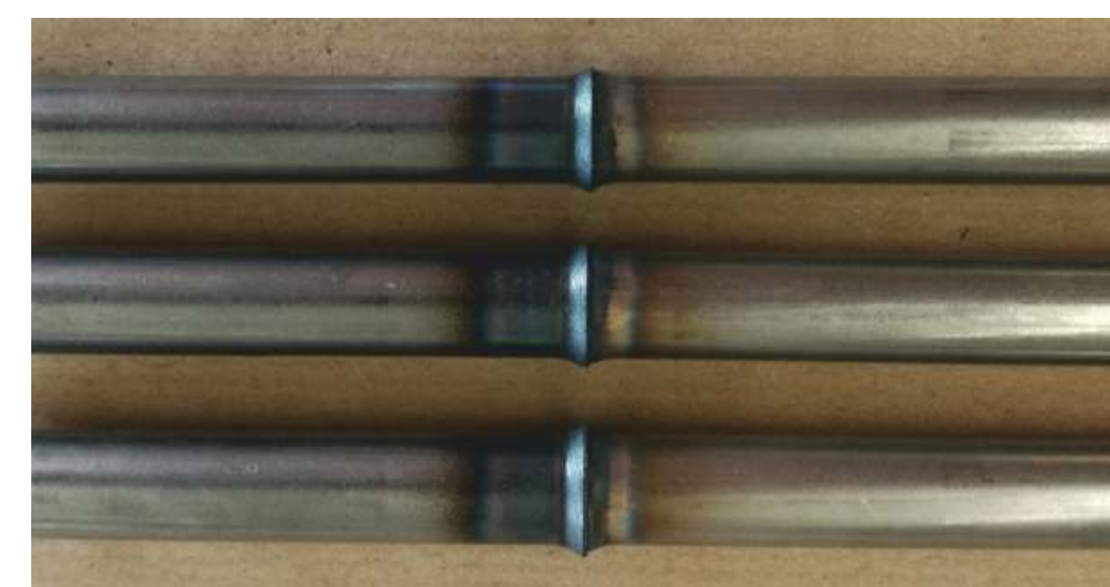
Rys. 5. Widok wybranych zgrzeiny ze stali automatowej 11SMnPb30 (po prawej) oraz stali nierdzewnej AISI304 (po lewej).
