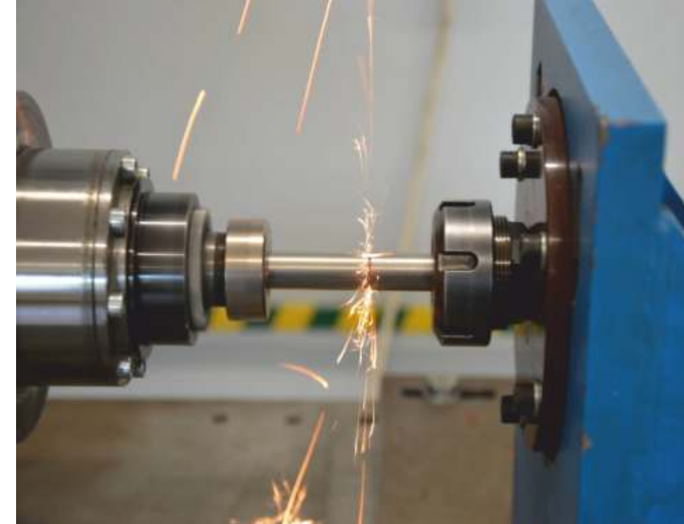
Rys. 4. Zgrzewanie elementów elektroaworów za pomocą technologii zgrzewania tarcioowego wysokoobrotowego - HSFW
