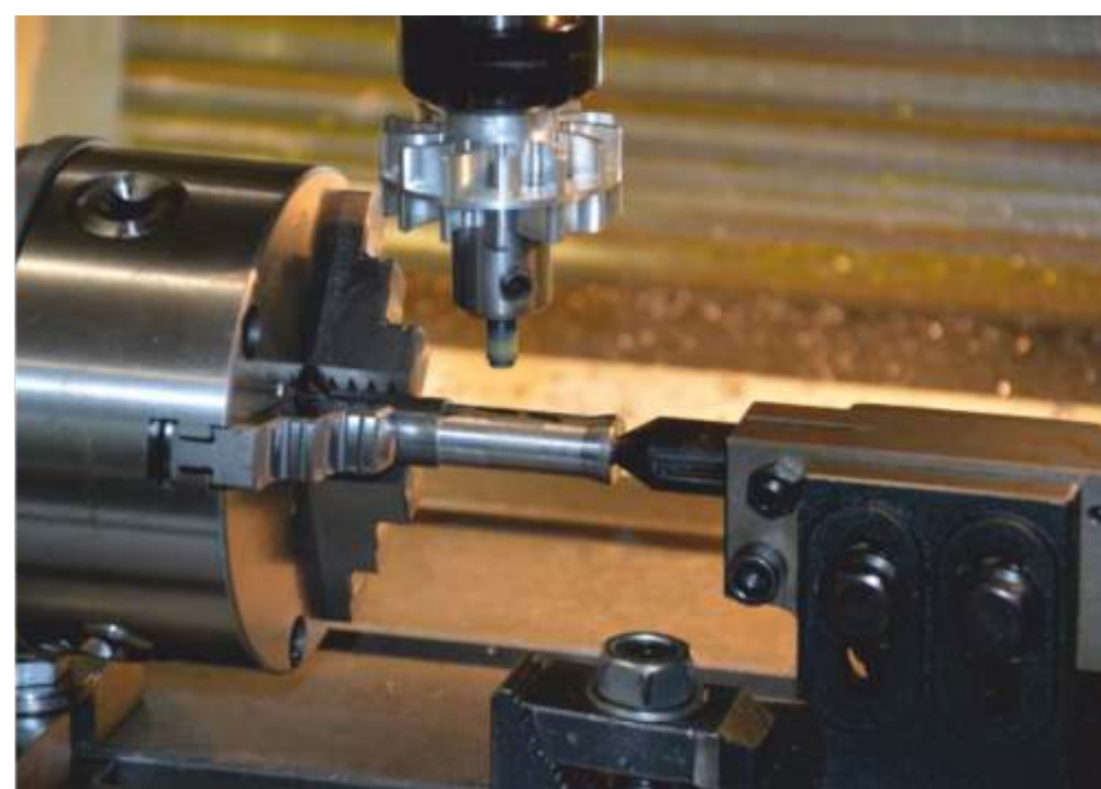
Rys. 2. Stanowisko do obróbki zgrzeiny HSFW za pomocą zgrzewania tarcioowego FSW
