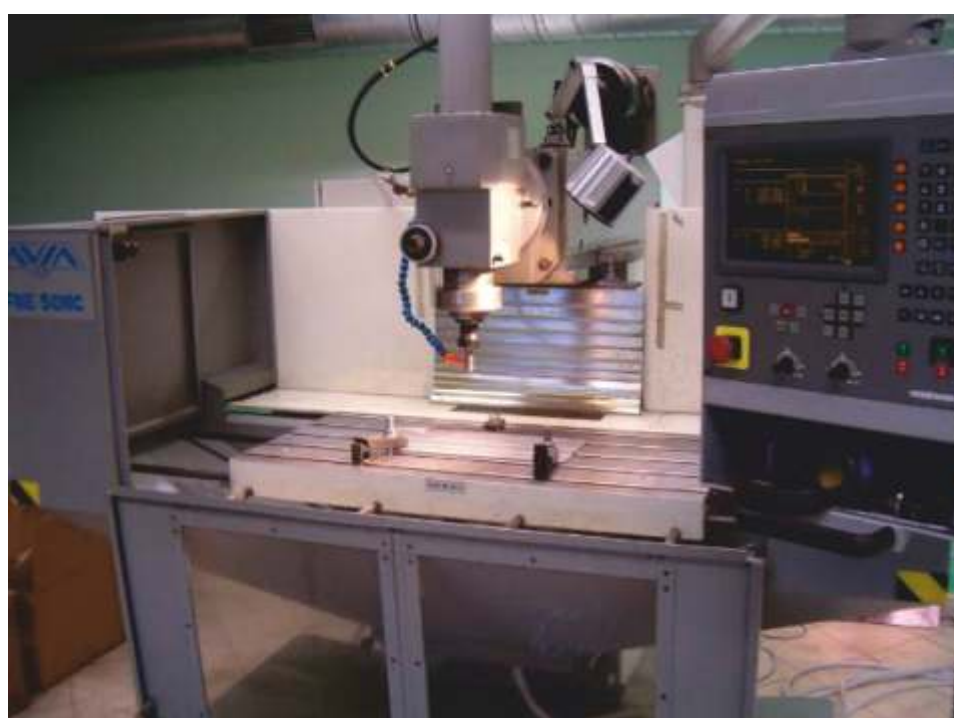
Rys. 2. Stanowisko do obróbki zgrzeiny HSFW za pomocą zgrzewania tarcioowego FSW
