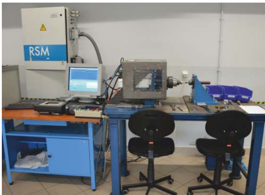
Rys. 1. Stanowisko do zgrzewania wysokoobrotowego HSFW w Łukasiewicz-Instytut Spawalnictwa
