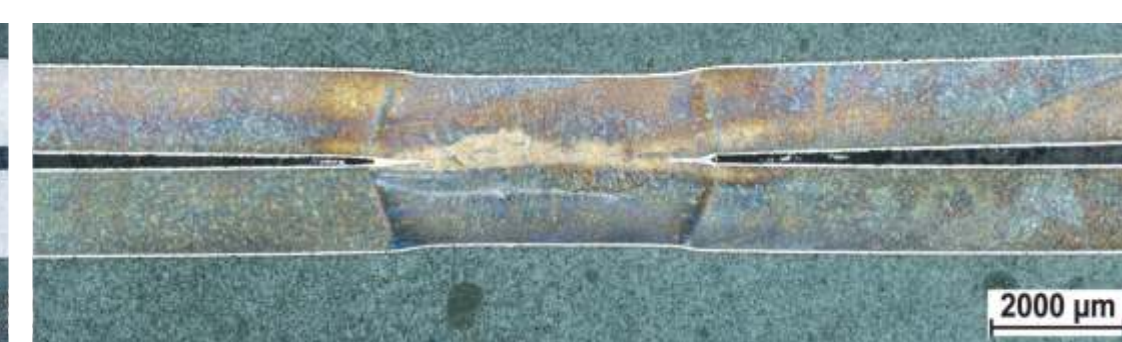
Rys. 4. Makrostruktura złącza ze stali 22MnB5 AS 60/60 klejowo zgrzewanego. Widok ogólny
