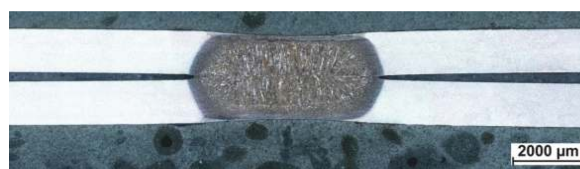
Rys. 3. Makrostruktura złącza ze stali HC340LA ZE50/50 Granocoat ZE klejowo zgrzewanego. Widok ogólny
