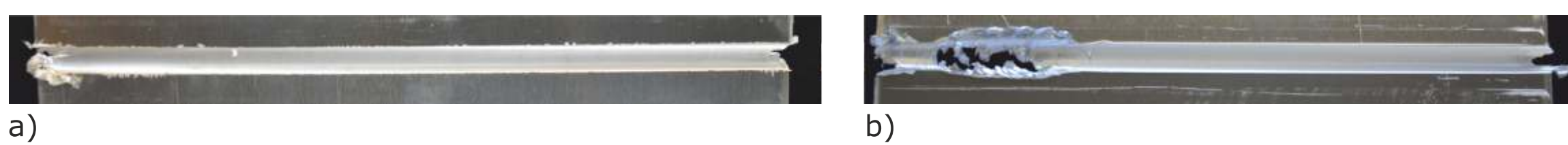
Rysunek 2. Widok złączy wykonanych narzędziem bobbin-tool: a) grubość 2,0 mm; \omega = 710 obr/min, v_{zg} = 112 mm/min, b) grubość 3,0 mm; \omega = 560 obr/min, v_{zg} = 560 mm/min
