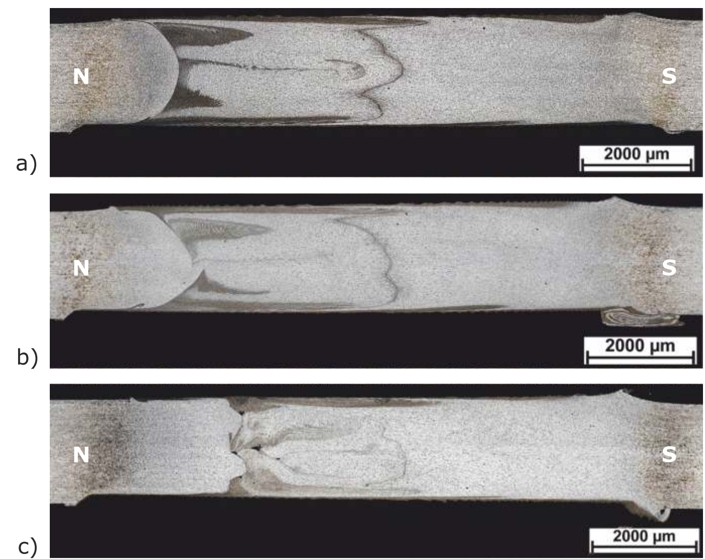
Rysunek 3. Wyniki badań metalograficznych makroskopowych złączy o grubości 2,0 mm. Parametry zgrzewania: a) \omega = 900 obr/min; v_{zg} = 112 mm/min, b) \omega = 1120 obr/min; v_{zg} = 112 mm/min, c) \omega = 1800 obr/min; v_{zg} = 112 mm/min. N – strona natarcia, S – strona spływu
