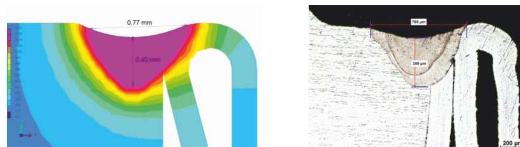
Rys. 6. Geometria i wymiary spoiny obliczonej (z lewej) i rzeczywistej (z prawej)
