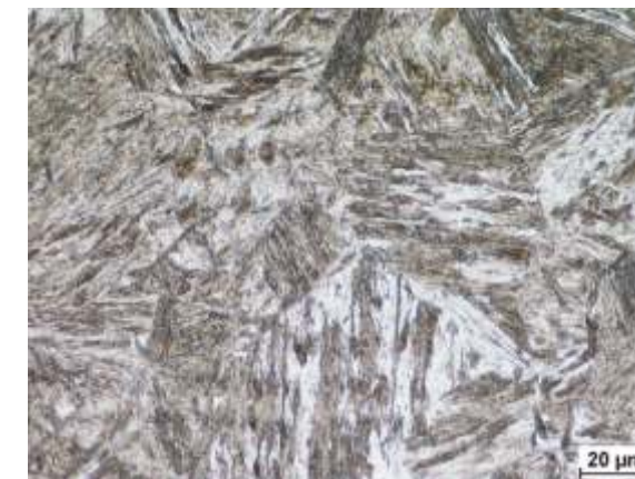
Mikrostruktura SWC. E = 1,42÷1,62 kJ/mm. Martenzyt. 464 HV10
