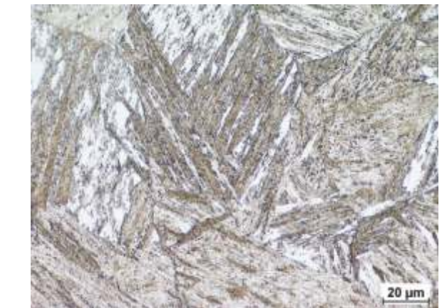
Mikrostruktura SWC złącza po 4. naprawie. Martenzyt i niewielka ilość ferrytu. 420 HV10
