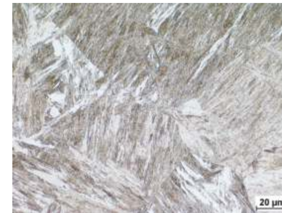
Mikrostruktura SWC złącza po 1. naprawie. Martenzyt i niewielka ilość ferrytu. 444 HV10
