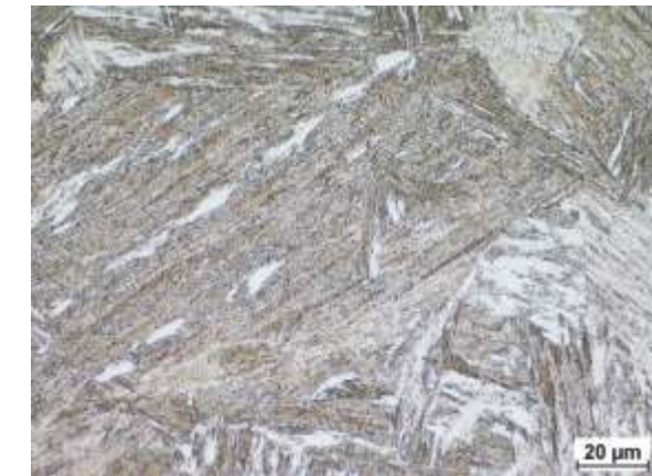
Mikrostruktura SWC złącza po 4. naprawie. Martenzyt i niewielka ilość ferrytu. 425 HV10
