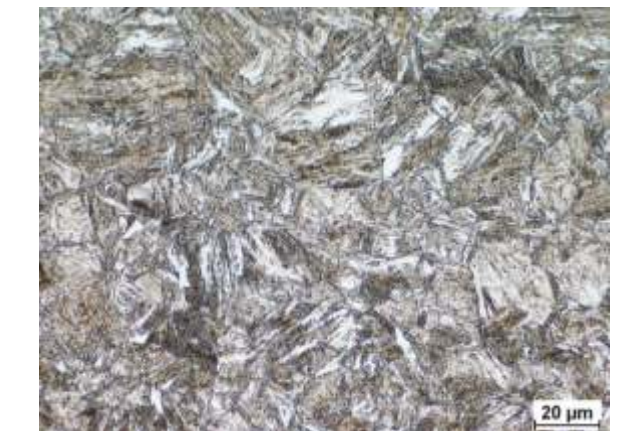
Mikrostruktura SWC. E = 8,36÷9,56 kJ/mm. Martenzyt. 430 HV10
