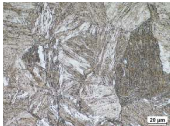
Mikrostruktura SWC złącza po 1. naprawie. Martenzyt i niewielka ilość ferrytu. 432 HV10
