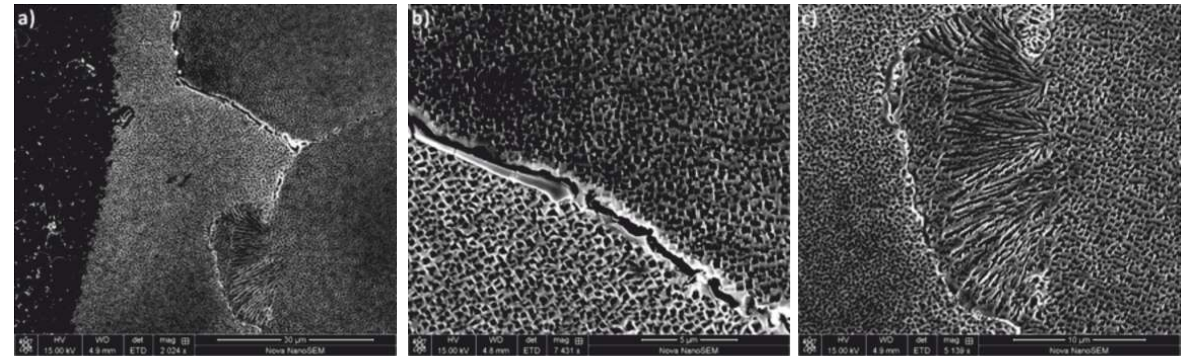
Rys. 3. Pęknięcia likwacyjne w strefie wpływu ciepła w Rene 77: a) lokalizacja pęknięcia; b) likwacja na granicy dendrytów; c) propagacja pęknięcia wzdłuż eutektyki γ-γ'
