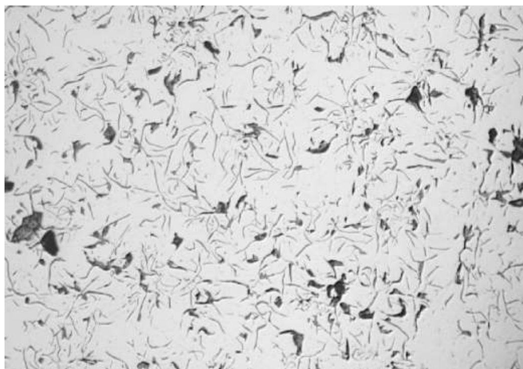
Rys. 3. Zgląd nietrawiony, grafit płatkowy. Pow. 100x. Zgląd trawiony, grafit płatkowy z osnową perlityczną. Pow. 400x
