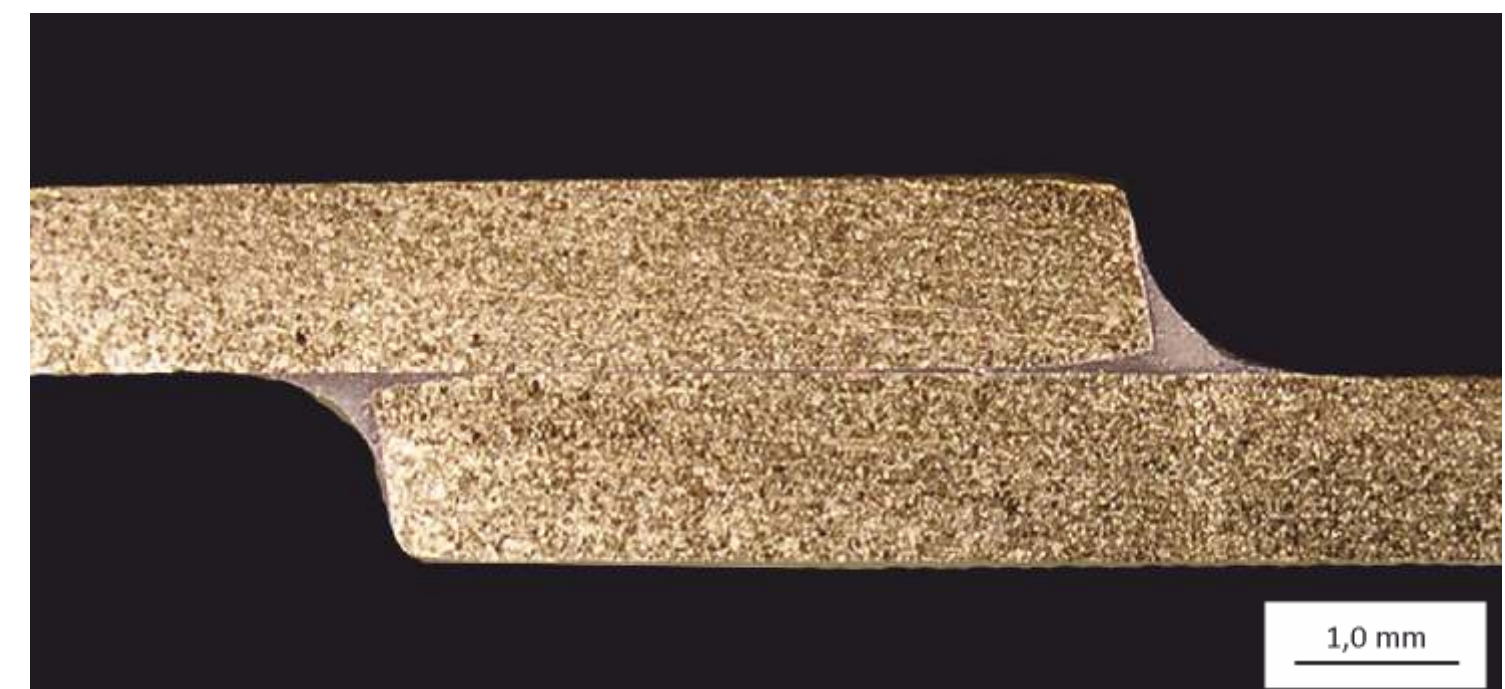
Rys. 5. Makrostruktura połączenia zakładkowego z mosiądzu CW508L wykonanego spoiwem srebrnym w gat. Ag 245 i topnikiem F10, traw. FeCl 3
