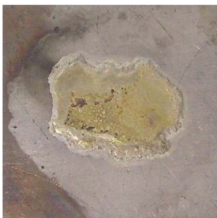
Rys. 2. Rozpląwność spoiwa srebrnego w gat. Ag 245 na stali nierdzewnej w gat. X2CrNi18-9 z zastosowaniem topnika F6B
