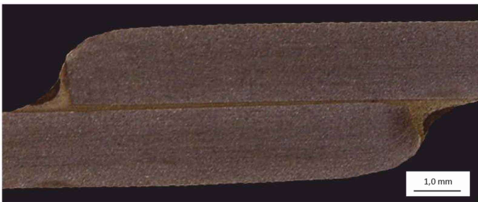
Rys. 1. Makrostruktura połączenia stali nierdzewnej X2CrNi18 - lutowanego spoiwem srebrnym otulonym w gat. Ag 145, traw. FeCl 3
