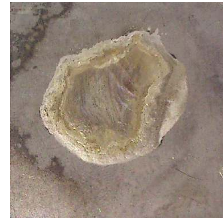
Rys. 4. Rozpląwność spoiwa srebrnego w gat. Ag 245 na stali nierdzewnej X2CrNi18-9 z zastosowaniem topnika F10
