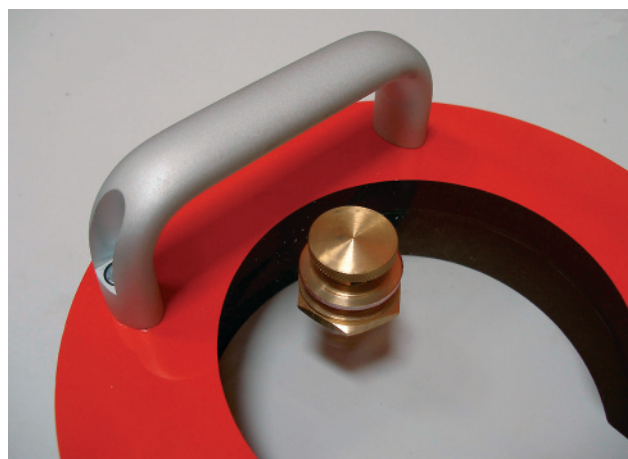
Rys. 5. Widok nowego uchwytu transportowego przyssawki próżniowej i jej zaworu zapowietrzającego
