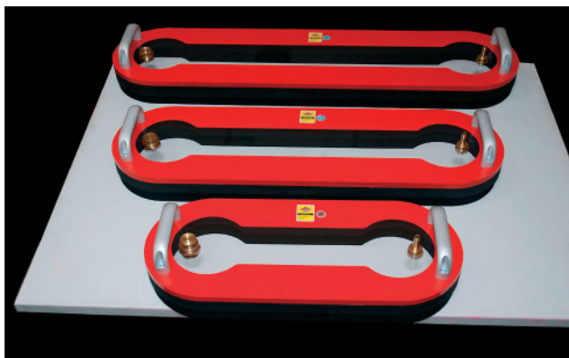
Rys. 3. Przyssawki podłużne o długości odcinka przydatnego do badania równego (licząc od góry): 90 cm, 75 cm i 50 cm
