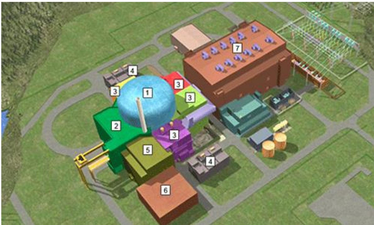
Rys. 1. Schemat elektrowni EPR z wyspą jądrową (1-6) i turbinową (7) [8].
